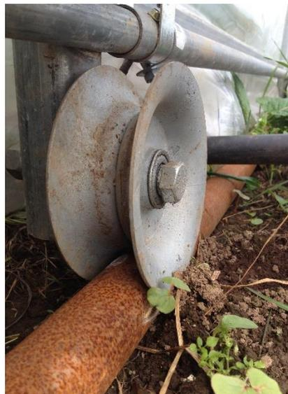
On voit bien sur cette photo le système qui permet au tunnel de se déplacer : des roues fixées au pied de chaque arceau et qui se déplacent sur des tubes ronds d'acier posés au sol. Les rails ne sont pas fixés directement au sol, et ce sont des amarres qui permettent de bloquer le tunnel une fois qu'il est déplacé.
