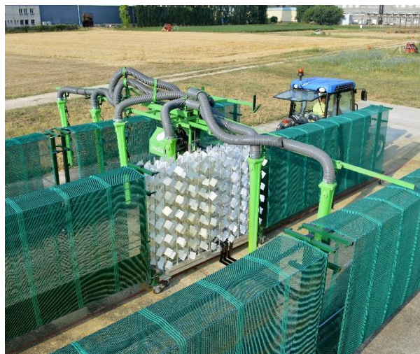
Figure 1. Schéma du banc d'essai EvaSprayViti en pleine végétation à gauche et photo du passage d'un appareil lors d'un essai à droite.
