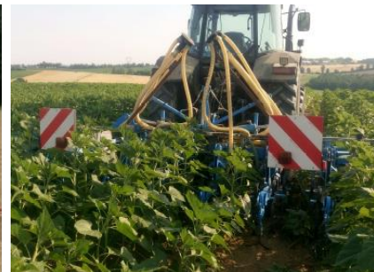
Herse étrille et bineuse pour le désherbage mécanique
