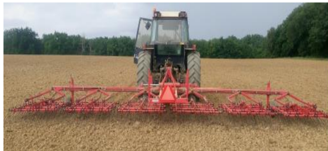
Herse étrille et bineuse pour le désherbage mécanique
