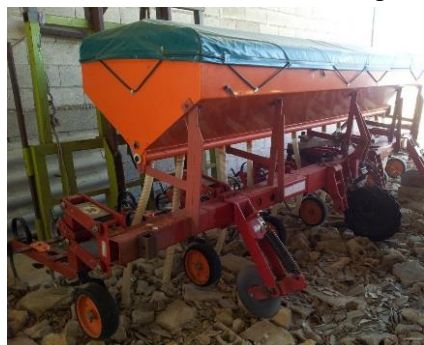
Association bineuse + trémie engrais
