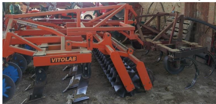
Association Vitolab + chisel : 2 interventions en 1 passage
