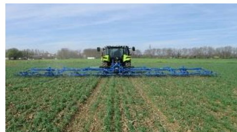
Herse étrille sur blé bien implanté, forte agressivité. Crédit photo : Unité Expérimentale d'Auzeville
