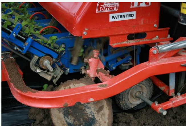
Planteuse sur paillage : Pose le plastique et plante simultanément.
