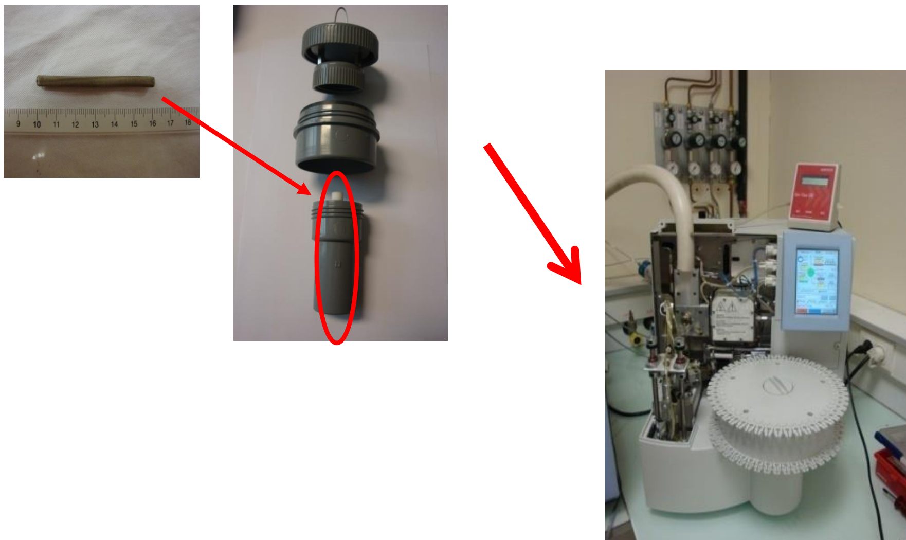
Figure 3 : Détail d'un capteur passif, de son abri et du dispositif de désorption thermique
