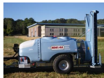
Aéroconvecteur à flux tangential
