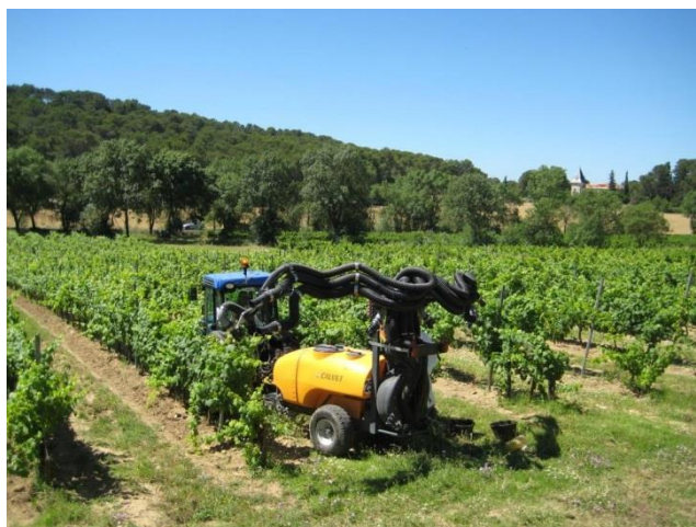
Figure 30 : Pulvérisateur de type voûte pneumatique 4 mains 4 canons dans une vigne
