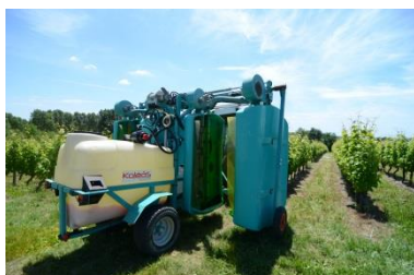
Face par face avec panneaux récupérateurs
