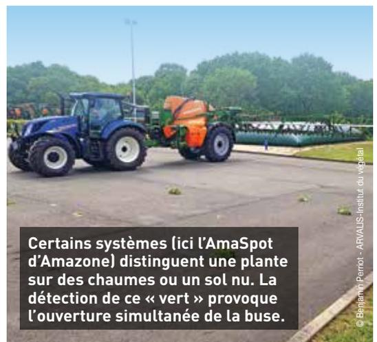
**Certains systèmes (ici l'AmaSpot d'Amazone) distinguent une plante sur des chaumes ou un sol nu. La détection de ce « vert » provoque l'ouverture simultanée de la buse.**
