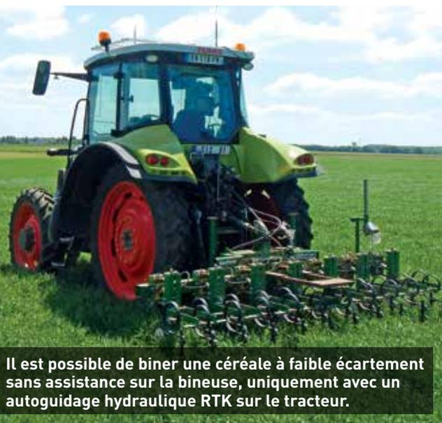
**Il est possible de biner une céréale à faible écartement sans assistance sur la bineuse, uniquement avec un autoguidage hydraulique RTK sur le tracteur.**
