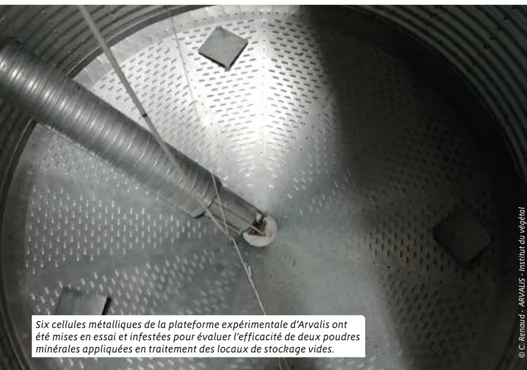
Six cellules métalliques de la plateforme expérimentale d'Arvalis ont été mises en essai et infestées pour évaluer l'efficacité de deux poudres minérales appliquées en traitement des locaux de stockage vides.
