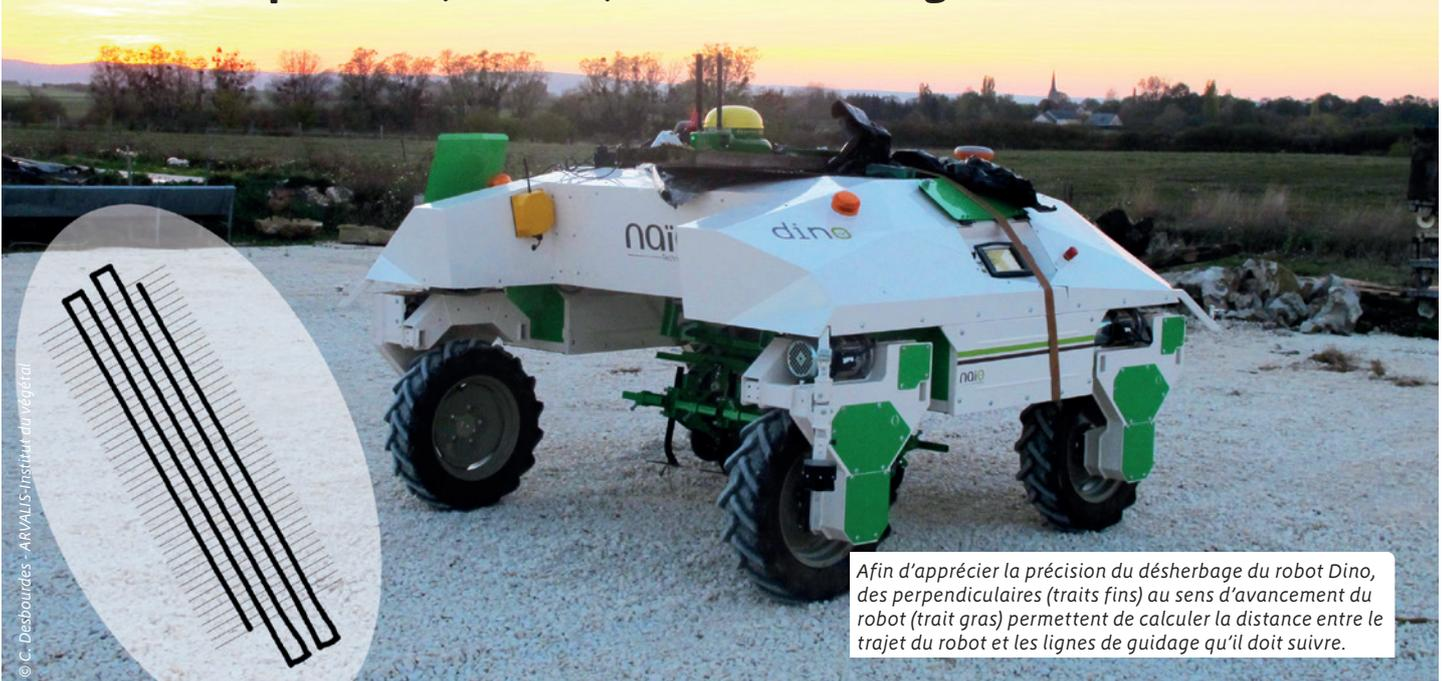
Afin d'apprécier la précision du désherbage du robot Dino, des perpendiculaires (traits fins) au sens d'avancement du robot (trait gras) permettent de calculer la distance entre le trajet du robot et les lignes de guidage qu'il doit suivre.
