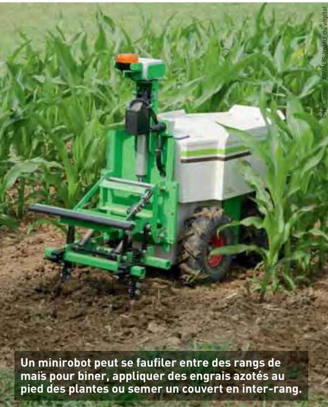
Un minirobot peut se faufiler entre des rangs de maïs pour biner, appliquer des engrais azotés au pied des plantes ou semer un couvert en inter-rang.
