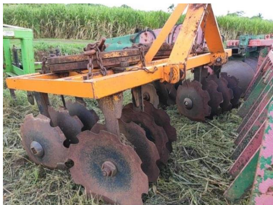
Sarcluse et herse canadienne, 2 exemples d'outils utilisés pour le désherbage des inter-rangs de canne à sucre.
