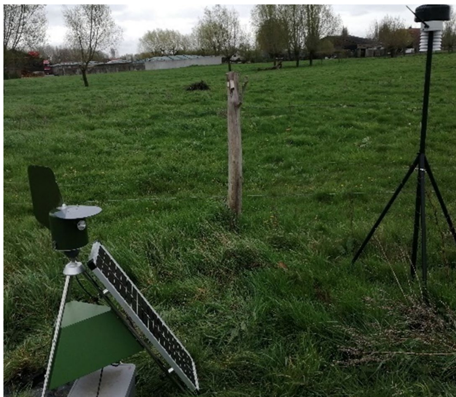
Photo 2 : Piège à spores et station météo connectée à Mileos® installés à Quesnoy-sur-Deûle-59 (ARVALIS)
