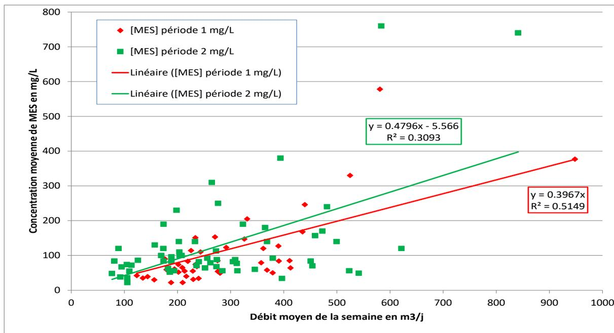
**Figure 31 : Comparaison des charges en MES en fonction du débit moyen hebdomadaire avant et après installation des plantes de couverture.**
