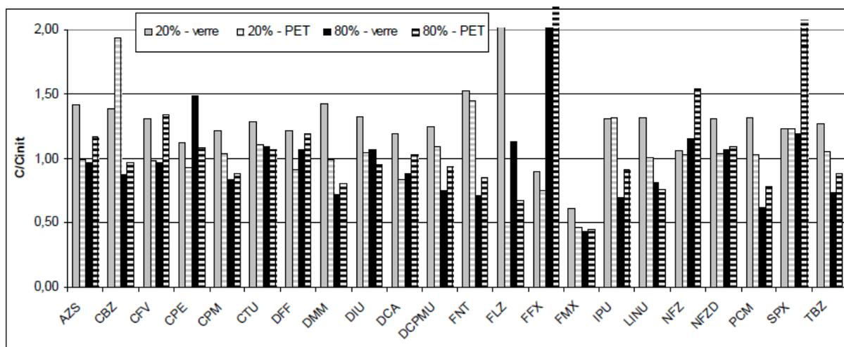
**Figure 13 : Evolution des concentrations en pesticides par rapport à la concentration initiale, pour les deux niveaux de dosage et un stockage de 2 jours au réfrigérateur en flacon verre et PET.**
