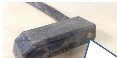
Les photos ci-dessus précisent les localisations du capteur dans la ravine ainsi que la position de l'orifice de bullage sur la sonde ( environ 2 mm de diamètre).
