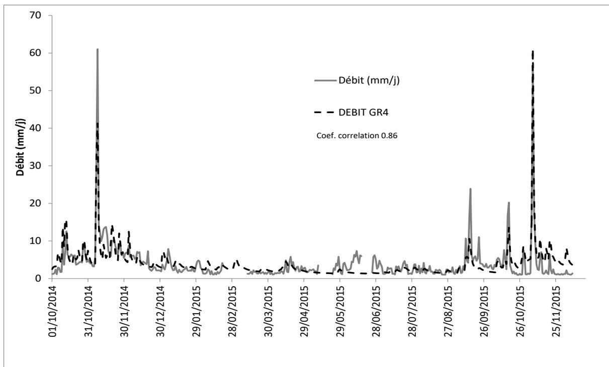
**Figure 23 : Comparaison des débits (mm/j) observés et simulés avec GR4J sur la période 2014-2015.**
