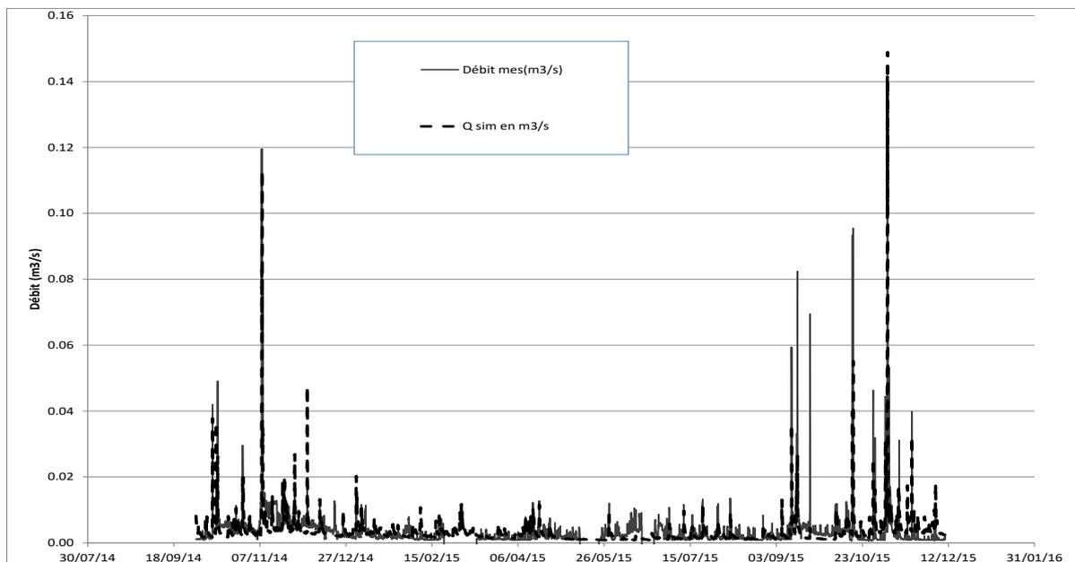
**Figure 24 : Comparaison débit observé et débit simulé par GR4H au pas de temps horaire sur la période 2014-2015.**
