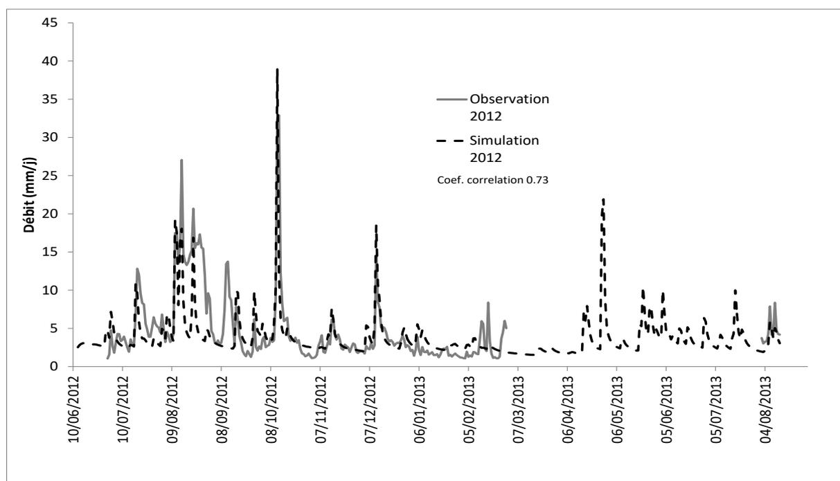
**Figure 22 : Comparaison des débits (mm/j) observés et simulés avec GR4J sur la période 2012-2013.**
