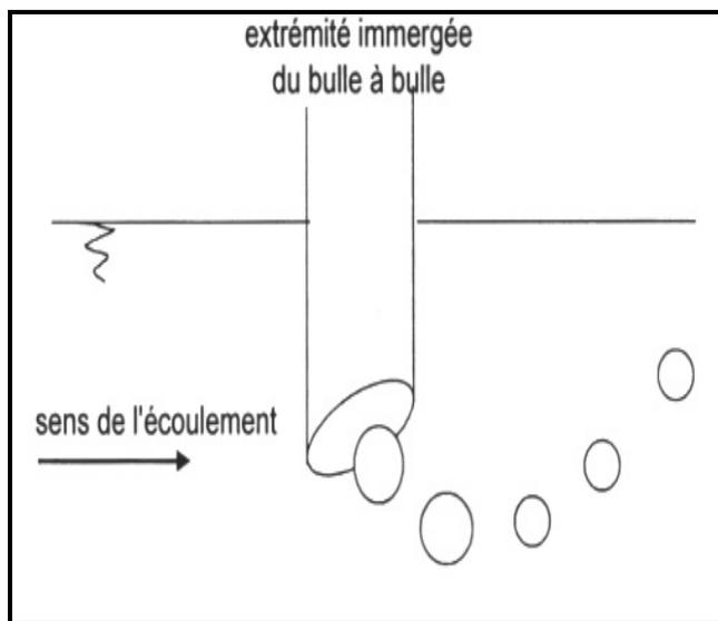
Le capteur dit bulle à bulle repose sur le principe de mesure de pression hydrostatique mais contrairement au capteur de pression classique où le capteur et la partie sensible sont immergés dans l'eau, le capteur est ici émergé.
