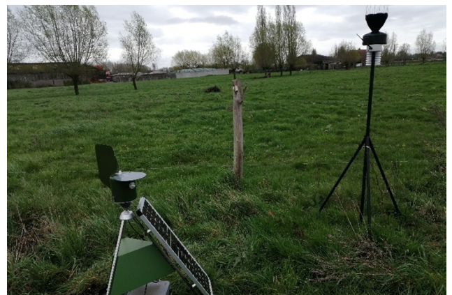
Piège à spores et station météo connectée à Mileos® installés à Quesnoy-sur-Deûle-59 -- @ARVALIS
