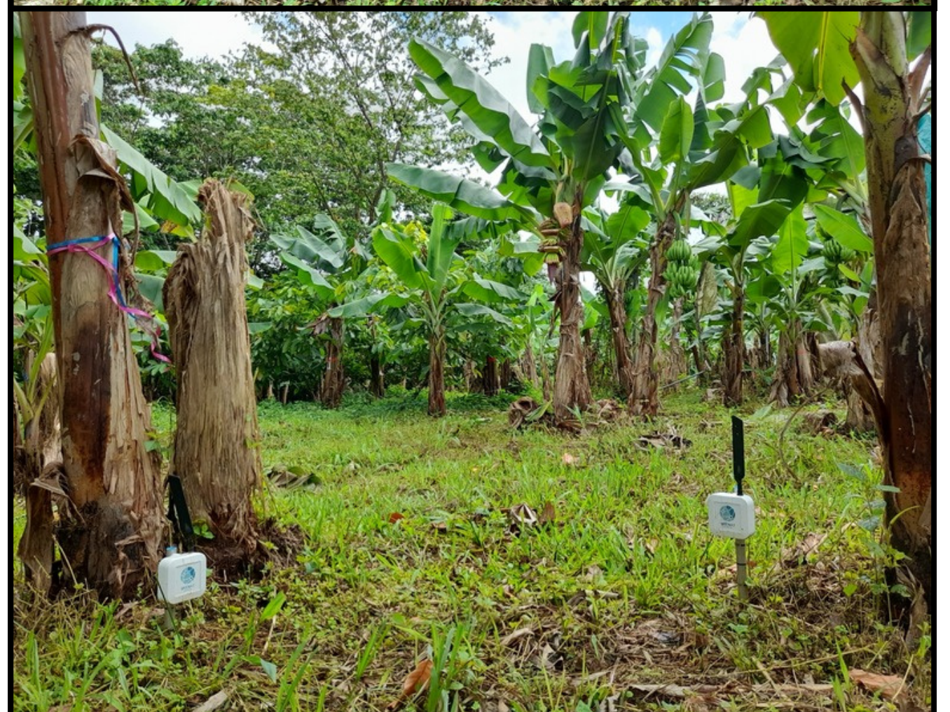
Outils de monitoring implantés sur le site expérimental : stations météo (en haut) et tensiomètres (en bas) Avril 2025 © Grégoire Bernot
