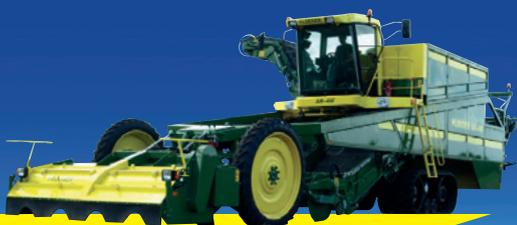
Arracheuse automotrice sans trémie
