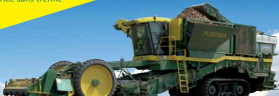
Arracheuse automotrice avec trémie
