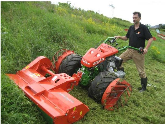
Photo 4. Agria Taifun similaire au Bison avec safety mulcher et roues cage jumelée pour une utilisation en pente.
