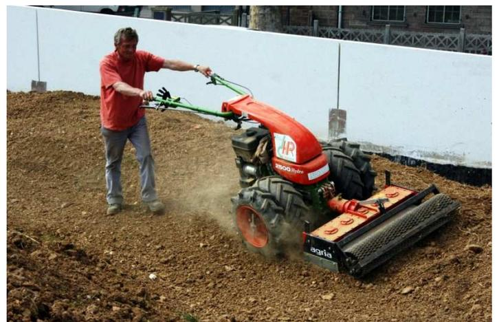
Photo 3. Agria 2500 avec herse rotative et pneumatiques jumelés.
