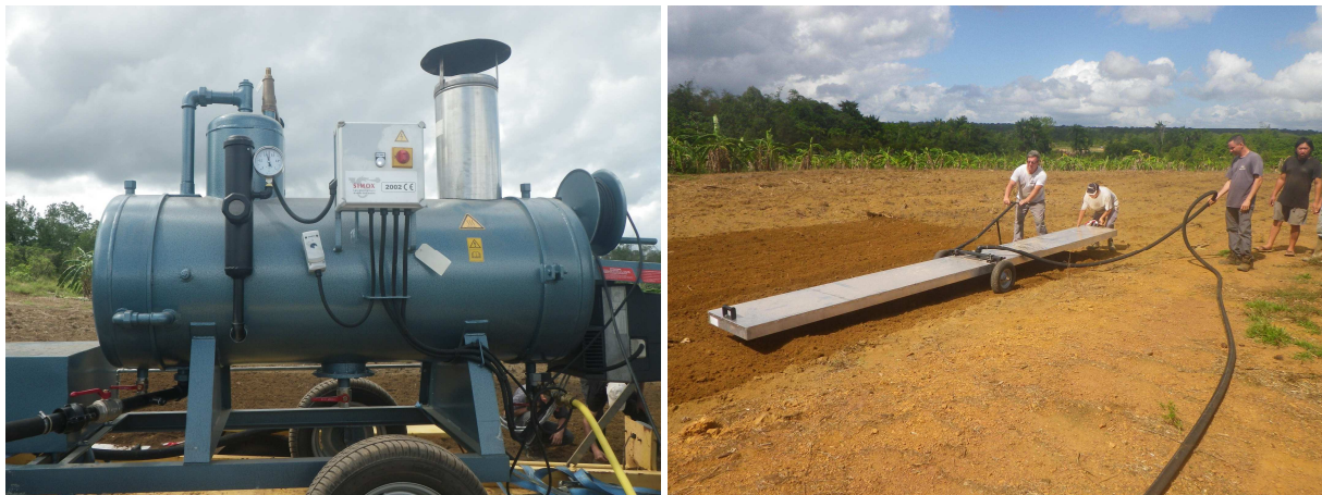
Photos 9 et 10 : Appareil de désinfection du sol à la vapeur (30/11/2015 - photo DAAF)
