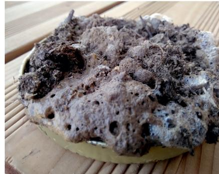
Test du carbone labile - formation de mousse et nombreuses bulles
