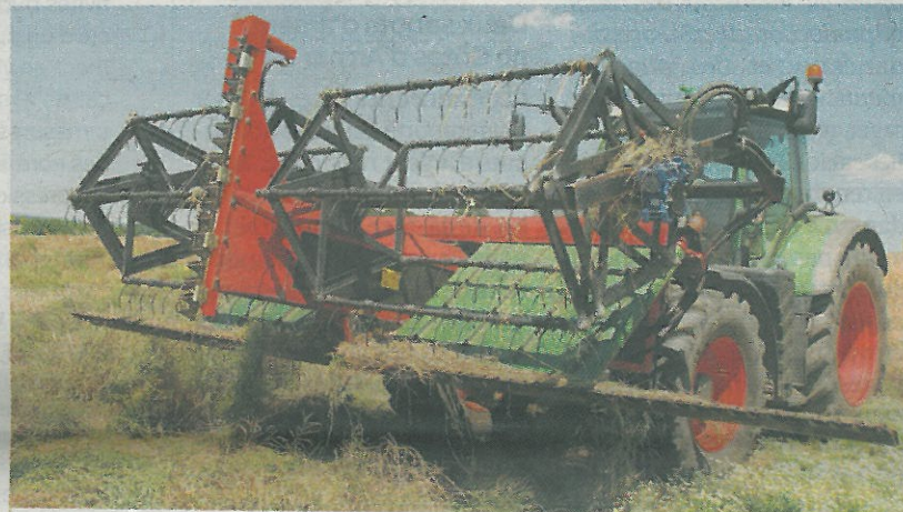
Le diviseur axial sépare la culture en deux, et la largeur de coupe est aujourd'hui de 6,20 m (5,75 m ici). 40 cm ont été ajoutés aux tapis tournant.
