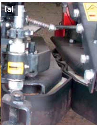
L'équipement EnviMaxX de Rema arrache tangentiellement les fanes à l'aide de bandes souples caoutchoutées (a) tandis que des palettes (b) maintiennent les buttes.
