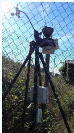
Légende : Station météo agricole connectée utilisée pour les modèles de prévision de maladie (anticipation de l'arrivée potentielle d'une contamination tavelure). Permet de positionner correctement les dates de traitements (économie du nombre de passages et sécurise la production).
