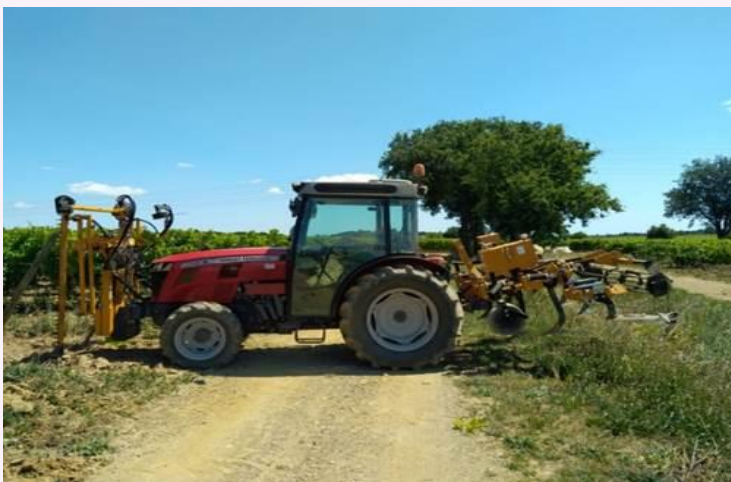
Légende : campagne 2020, combinaison de travaux mécaniques : entretien de l'inter-rang + entretien du rang + rognage
