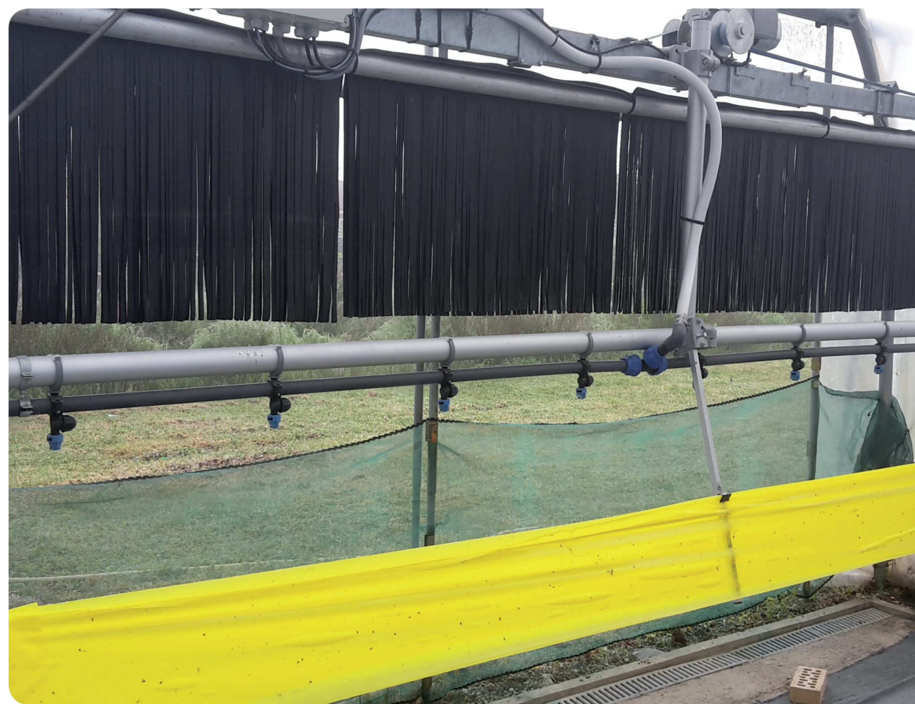
Chariot de stimulation mécanique avec bâche EPDM et bandes engluées
