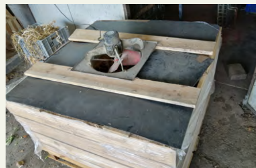
↑ Ventilateur fixé sur le palox en haut de colonne
