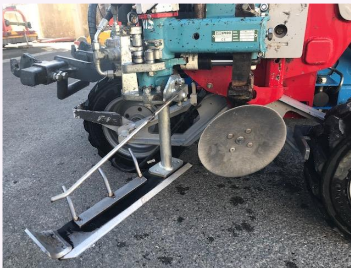
Légende: Détail des lames inter-ceps montées sur l'Emisol
