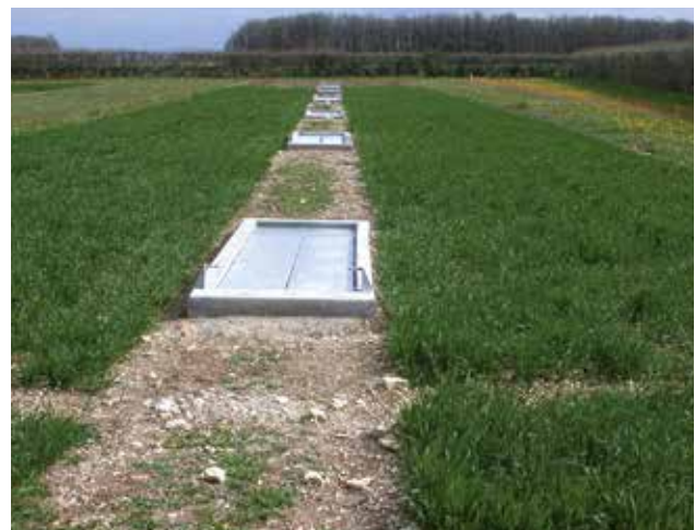
Figure 1 : Dispositif Magneraud : parcelles et fosses d'accès aux lysimètres (crédit photo : ARVALIS-Institut du végétal).
