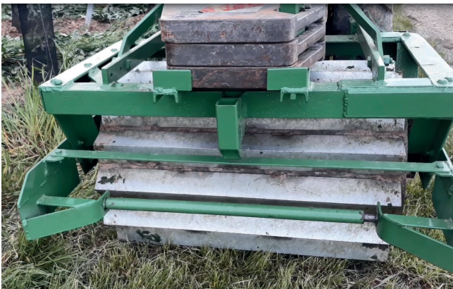
Exemple du rouleau auto-construit par le viticulteur Paul Bulber
