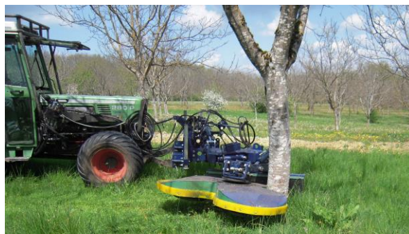
Figure 1: Faucheuse à triple tête.
