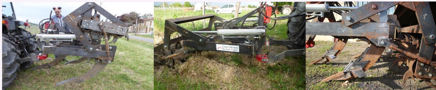
Légende : Réhabilitator avec rouleaux sur le cadre, outil prêt au travail avec les dents enfoncées, zoom sur les dents de l'outil
