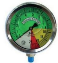
À la mise en service, comparez l'exactitude du manomètre de service avec un autre manomètre
