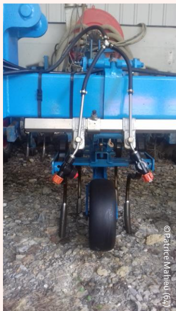
Légende : Bineuse équipée d'un système de pulvérisation
