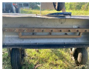
Rampe en cloche de 80 cm de large passée sur les passe-pieds. Projection de micro-gouttelettes d'eau à 100 °C entraînant l'éclatement des cellules végétales et la mort des plantules.
