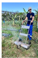
Rampe en cloche de 80 cm de large passée sur les passe-pieds. Projection de micro-gouttelettes d'eau à 100 °C entraînant l'éclatement des cellules végétales et la mort des plantules.
