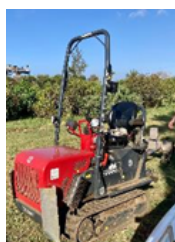
Désherbeur Oeliatec Houat 500 (cuve d'eau de 500 L) tracté par un microtracteur
