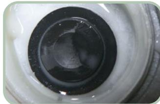
Dépôt de membrane **inexistant** sur le corps du piston.
