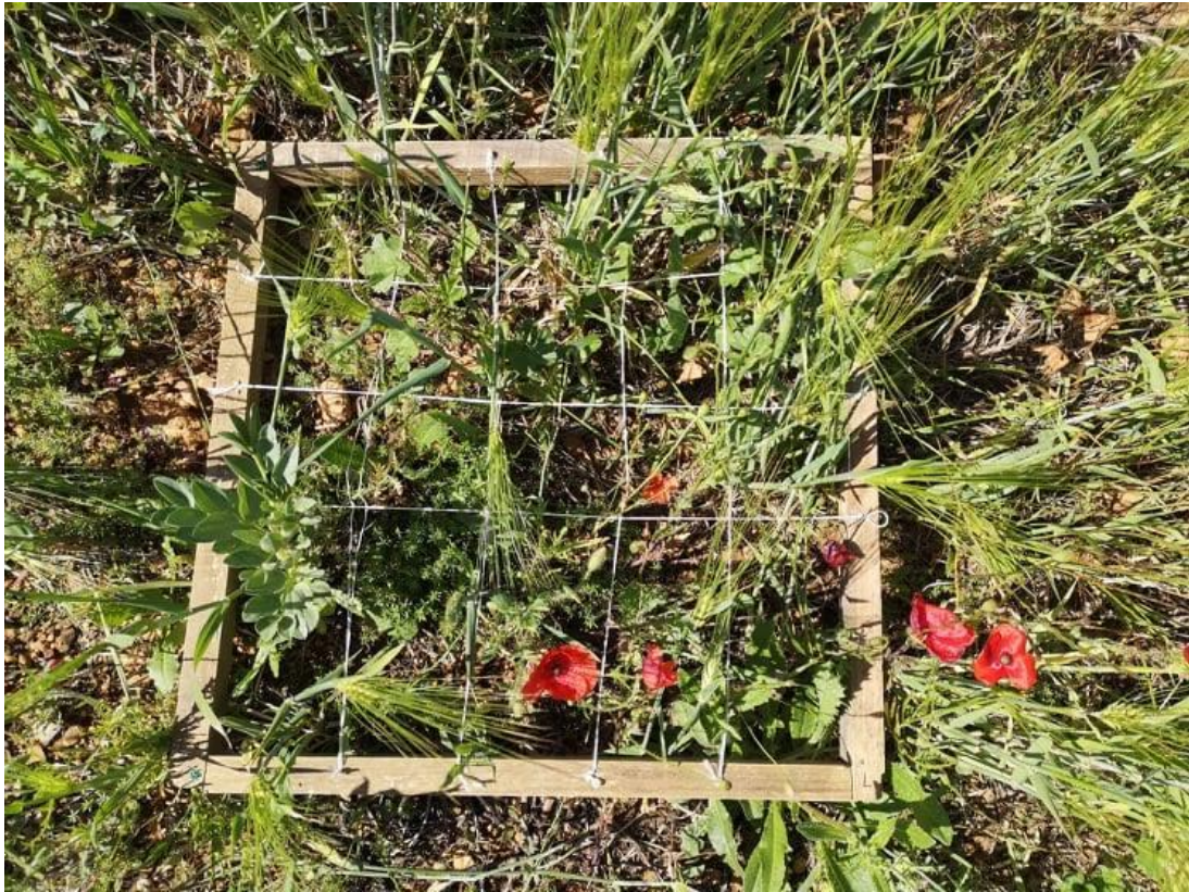
Figure 11 : Quadrat de 0.50x0.50 cm utilisé pour la caractérisation des couverts (Source : L. Tabary)
