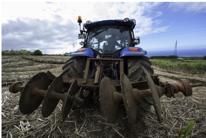
Disques mécaniques sur 2 inter-rangs (crédit Ministère)
