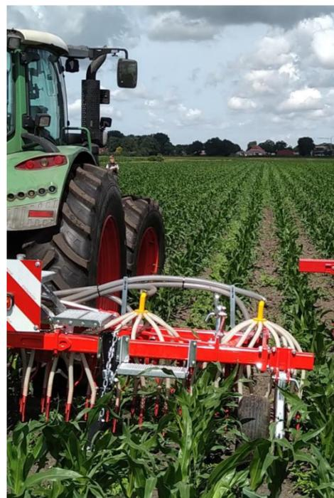
Désherbage mécanique : houe avec contrôle par caméra et contrôle de section assisté par GPS et herse intensive
