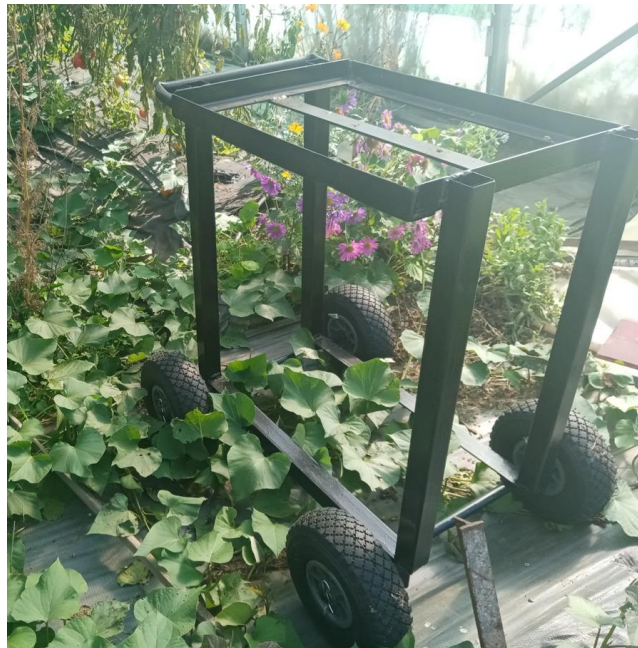
Chariot porte-caisse auto-construit
