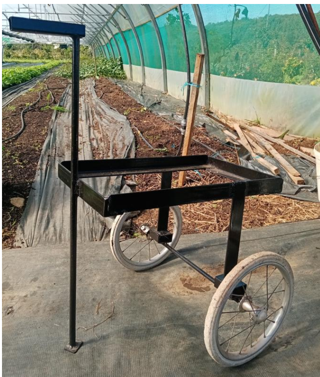
Chariot porte-caisse auto-construit
