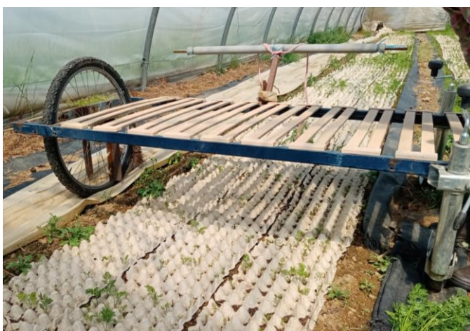
Support de lit de désherbage auto-construit
