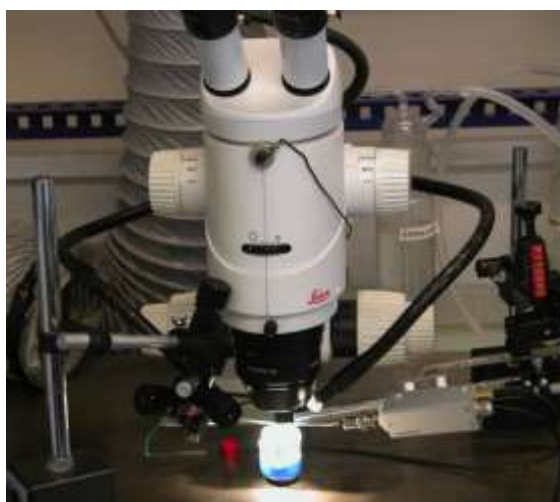
Figure 2 – Le poste d'électrophysiologie pour enregistrer étudier la détection des COV par les antennes de la Pyrale.
