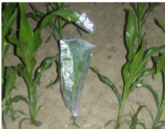
Figure 1 – Prélèvement d'odeurs du maïs dans l'espace de tête du maïs avec les fibres SPME.
